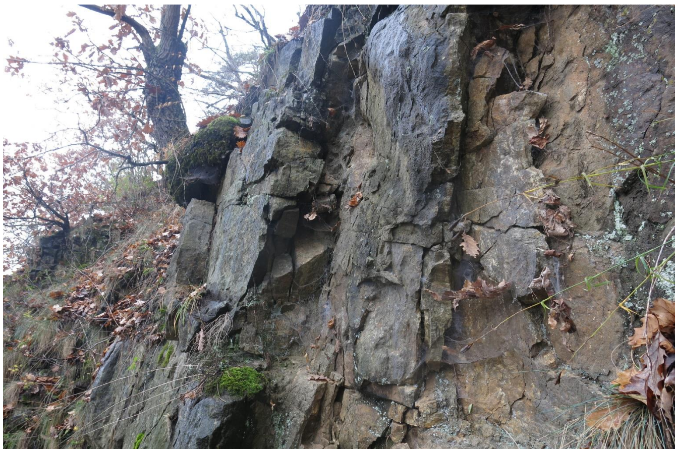
Deskovitě rozpukané bloky horniny ve velmi nestabilních polohách.
