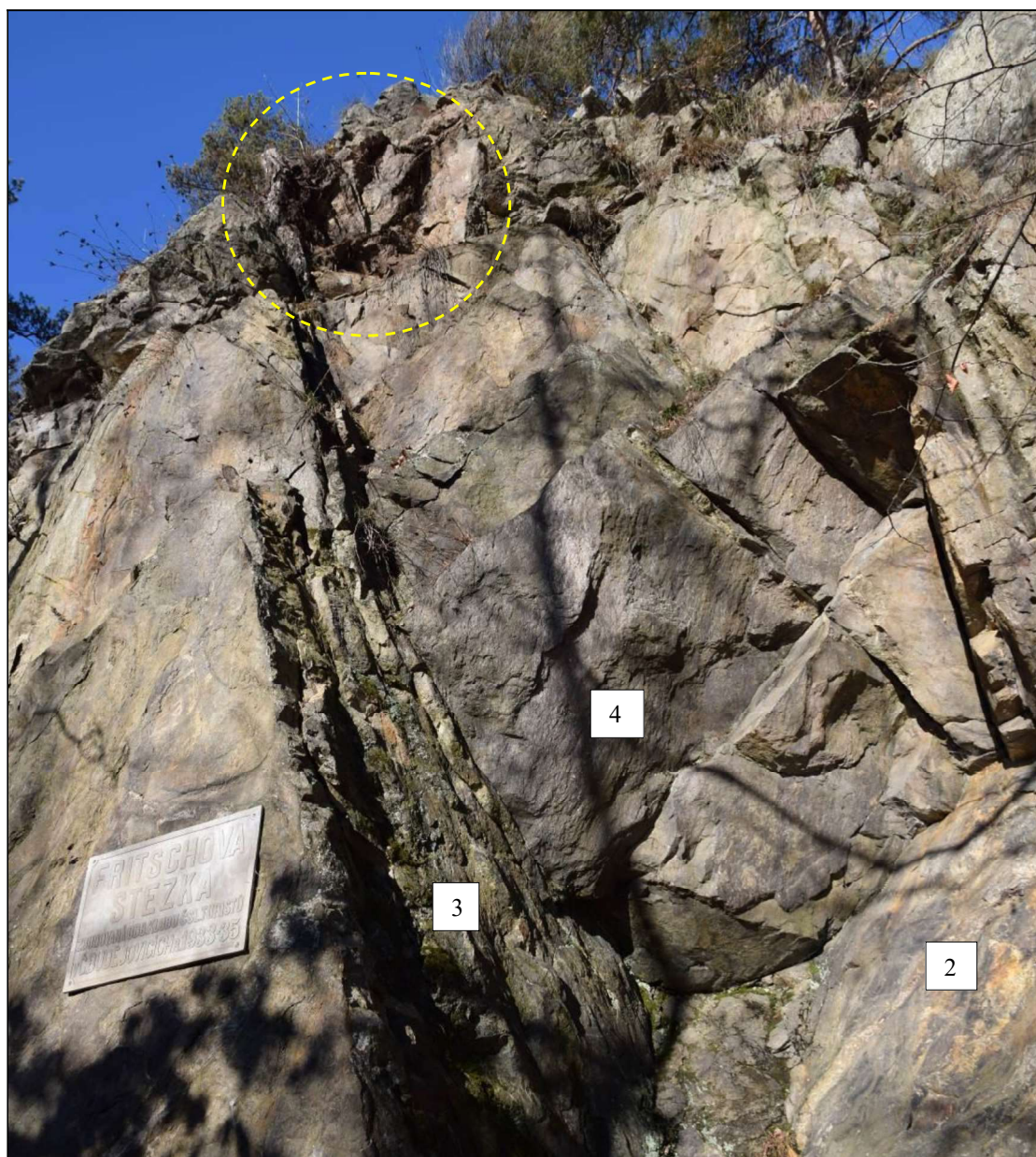
Foto 2 Pohled do skalní stěny v místě skalního řícení ze dne 4. listopadu 2023. Žlutou elipsou je vyznačena odlučná oblast předmětného řícení. Čísly jsou ve fotografii vyznačeny hlavní systémy diskontinuit shodné s čísly na obrázku 3, které se podílely na skalním řícení. Svůj podíl na příčinách skalního řícení měla i borovice v odlučné oblasti.
