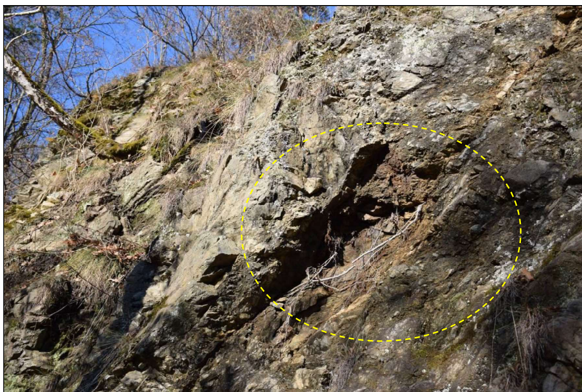
Foto 8 Místy se objevují lokální odlučné oblasti starších skalních řícení z partií tektonicky více porušených a silněji zvětralých hornin (zvýrazněno žlutou elipsou). Velikost odlučné oblasti je přibližně 0,5 \times 1 m.
